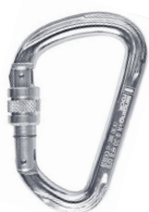
K5070PP D BIG CONNECTOR / screw gate polished ⬆ 30 kN ⬆ 8 kN ⬆ 9 kN gate opening (d) 24 mm 88 g (3.1 oz) unique production number CE 0333 ■ EN 362 ■ EN 12275
