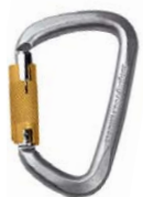
K4081ZD D STEEL CONNECTOR / triplelock with triple lock gate, key lock, zinc plated ⬆ 50 kN ⬆ 13 kN ⬆ 20 kN gate opening (d) 25 mm ■ 267 g [9,42 oz.] unique production number C€ 1019 ■ EN 362
