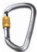
K4080ZD D STEEL CONNECTOR / screw with screw gate, key lock, zinc plated ⬆ 50 kN ⬆ 13 kN ⬆ 20 kN gate opening (d) 25 mm ■ 255 g [9 oz.] unique production number C€ 1019 ■ EN 362
